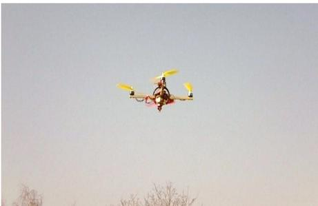
Die Basis-Stabilisierung hält den Copter in seiner aktuellen Fluglage, wenn kein Steuereingriff durch den Piloten erfolgt. Äußere Einflüsse - wie z.B. Windböen - werden - soweit physikalisch möglich - automatisch korrigiert.
