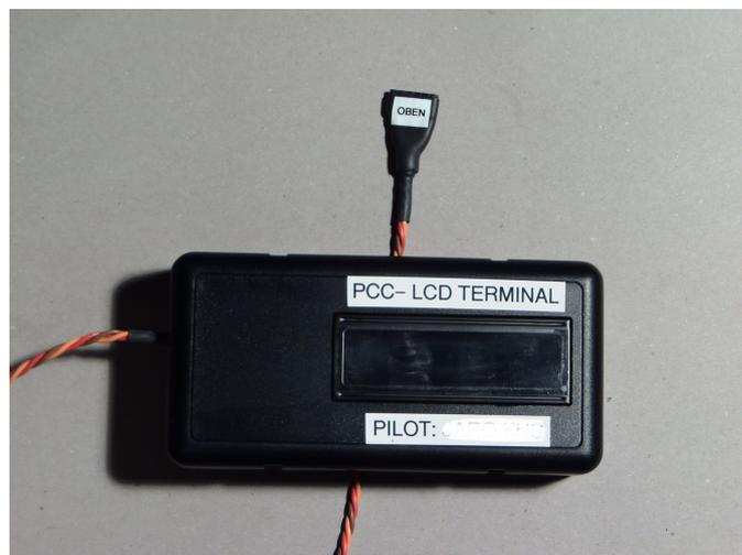
*Abbildung 17: LCD Terminal Gehäuse*
