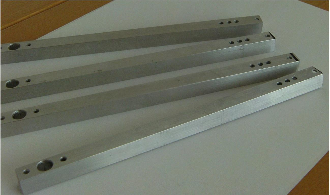
*Abbildung 2: Fertig gekürzte Ausleger*
